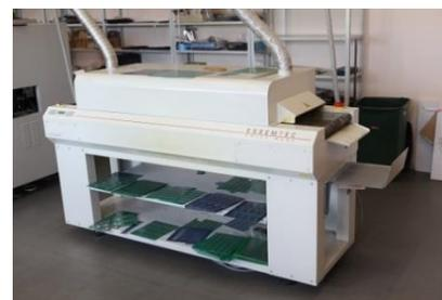
*На нашем производстве функционируют два SMD-робота: робот автоматического SMD-монтажа Yamaha и многозоновая паяльная печь конвекционного типа Essentec. Вся продукция проходит климатические испытания при температуре 45..+80°C, для этого используются специальные морозильные камеры и печи.*
