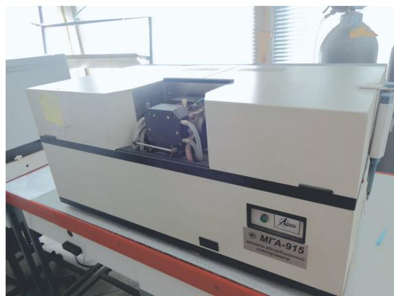
Атомно-абсорбционный спектрометр МГА-915 – прибор для определения содержания различных элементов в водных растворах, пищевых продуктах, биопробах, почвах
