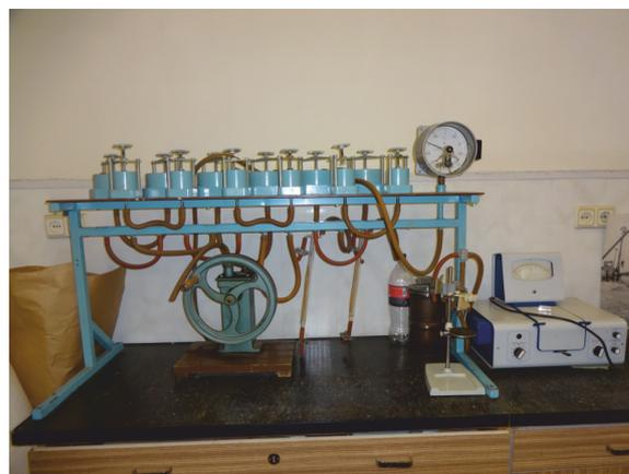
Капилляриметр – прибор для определения капиллярно-сорбционного давления почвенной влаги в зависимости от влажности почвы
